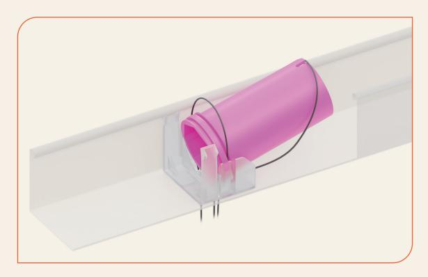
Certifique-se de que o cone esteja perfeitamente encaixado no cavalete, conforme indicado. Em seguida, mova o arco do cadarço para que ele se alinhe com o alojamento em V do cone.
