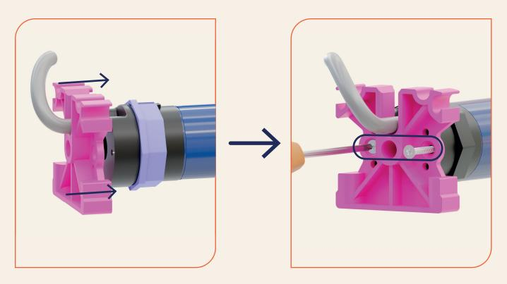
Insira o motor montado dentro do tubo. Gire o tubo de maneira que o motor entre perfeitamente mas mantendo os nós do cordão para baixo.
